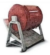
Барабан коксопробный (Микум барабан) предназначен для оценки качества кокса с точки зрения механической прочности по показателям М40, М25, М10 (I40, I25, I10) по ГОСТ 5953 (ИСО 556) «Кокс с размером кусков 20 мм и более. Определение механической прочности». Показатели механической прочности кокса активно используются (вместе с ситовым составом кокса) в оценке пригодности кокса для доменных печей дополняя показатели реакционной способности кокса (CRI) и послереакционной прочности кокса (CSR).
