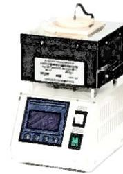
Аппарат предназначен для испытания угля по ГОСТР 59250 (ИСО 501:2012) «Уголь. Метод определения показателя свободного вспучивания в тигле».
