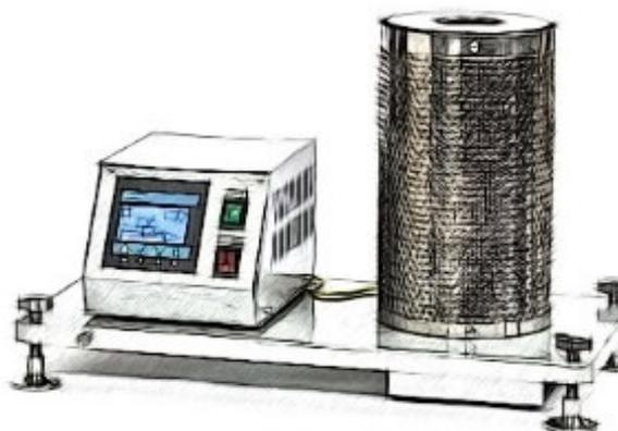
Аппарат предназначен для испытания угля по ГОСТ 32247 «Угли каменные. Метод определения числа вспучивания по ИГИ-ВУХИН». Аппарат позволяет определять способность спекающихся углей при нагревании в условиях свободного вспучивания в трубке давать коксовый остаток увеличенного объема за счет измерения разности между высотой угля (или его смеси с каменноугольным пеком) до и после нагревания его в трубчатой печи в течение 15 мин при температуре 550 °С.
